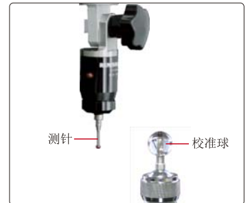
探针(选配), 包含 \varnothing 2\text{mm} 和 \varnothing 3\text{mm} 测针, \varnothing 25\text{mm} 校准球, 测量精度 10\mu\text{m}
